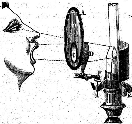
Fig. 1. — Faringoscopio montado en una lámpara.
