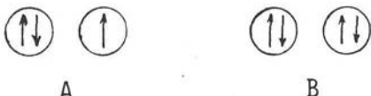
Figura 4. A: estructura electrónica del radical anión superóxido ( O_2^- ). Nótese que el oxígeno ha sufrido una reducción univalente por captación de un electrón, pero sigue siendo un radical pues tiene un electrón no apareado. B: peróxido. En la siguiente reducción univalente se obtiene peróxido de hidrógeno, que ya no es un radical, pues en cada orbital hay dos electrones de giro antiparalelo.
